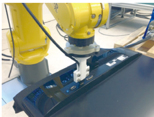
同社の技術を「コネクタ差し込み」に応用した例。 画像でコネクタを認識し、センサを使いながら差し込む動作をティーチングで行う
