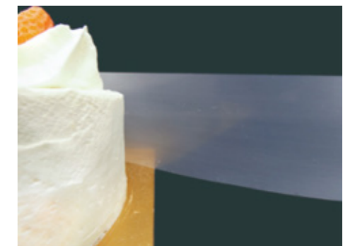
超撥油コートしたフィルムなら、剥がしたフィルムにクリームがくっつかない。
